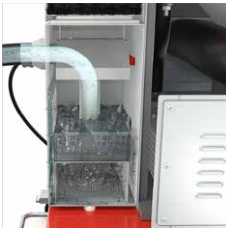
Einsaugen reaktiver Partikel
