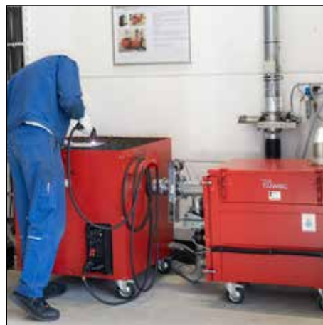
NA 250 Stahlblech ohne Reststaubfilter beim Plasmaschneiden
