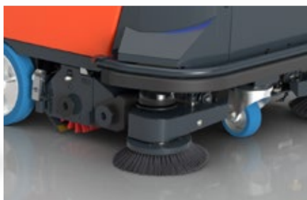
Walzenbürste und Seitenbesen ermöglichen Nassreinigung und Kehren in einem Arbeitsgang.
