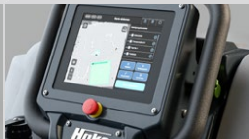
Das 8-Zoll-LCD-Panel stellt alle relevanten Informationen übersichtlich dar.
